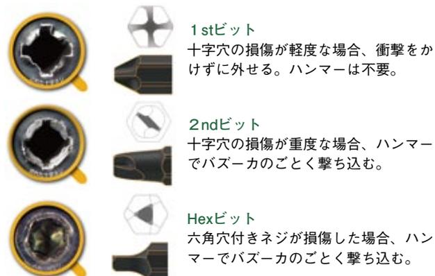
プラスネジの損傷程度に応じて1stと2ndビットを使い分けます。Hexビットは、頭が出ていない場所でもよく使用される六角穴付きネジを外すことができます。
